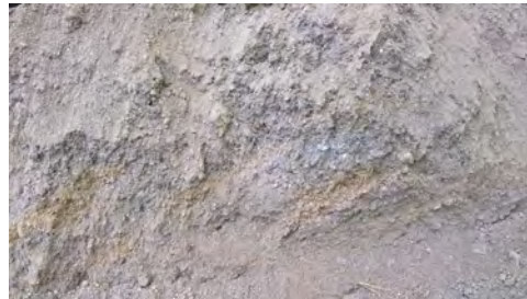
Figure 164 : terre stabilisée avec la chaux et 10% d'humidité.
