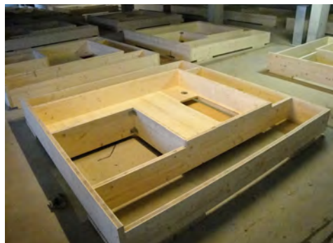
Figure 26: Caissons préfabriqués vides
