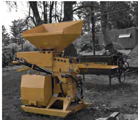
Figure 101 : BP714 Earth Blox machine,
