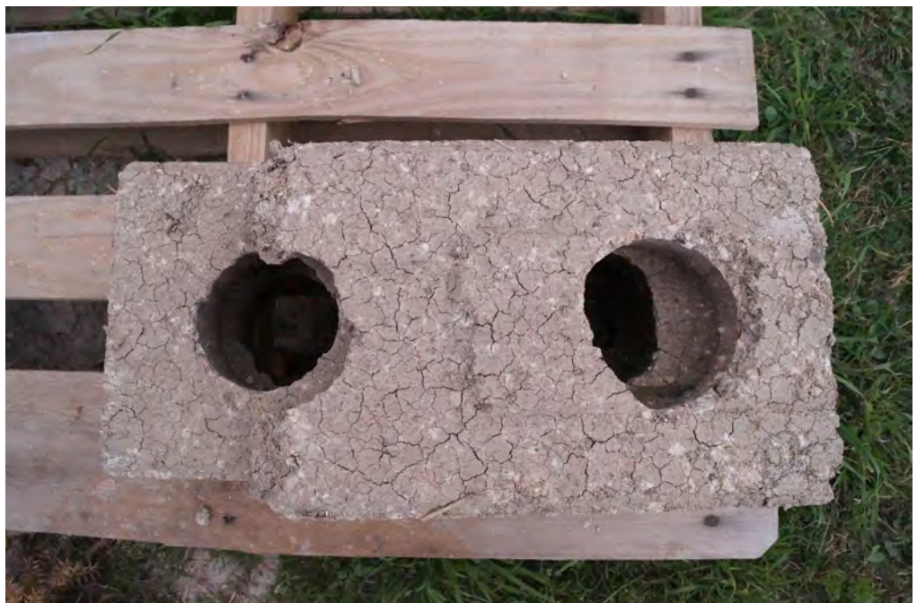
Figure 106 : BTC avec la terre non stabilisée et séchée au soleil et vent.
