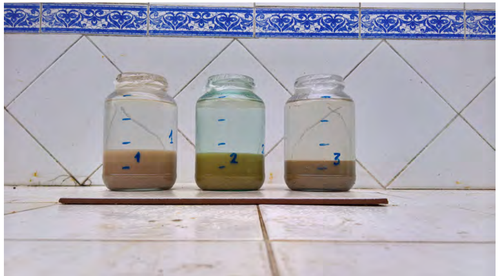
Figure 104 : Test de sédimentation avec trois terres différentes
