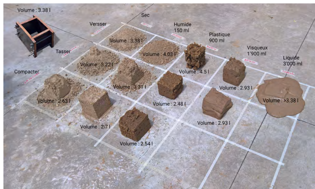
Figure 10 : Test Carazas avec les résultats
