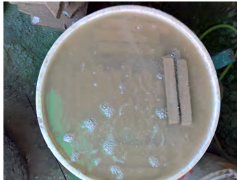
Figure 65 : Briques dans l'eau.
