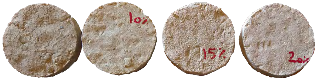
Figure 105 : Test pourcentage de sable avec terre.
