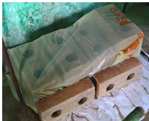
Figure 111 : Curage des briques
