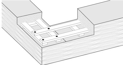
Schéma du principe d'assemblage pisé et bois
