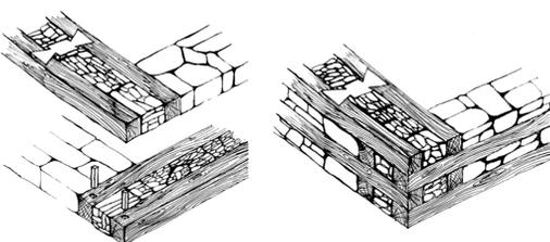
Schéma du principe d'assemblage pierre et bois
